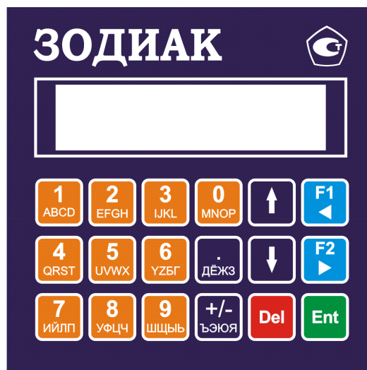
Рисунок А.1 – Панель клавиатуры с вырезом для индикатора.
