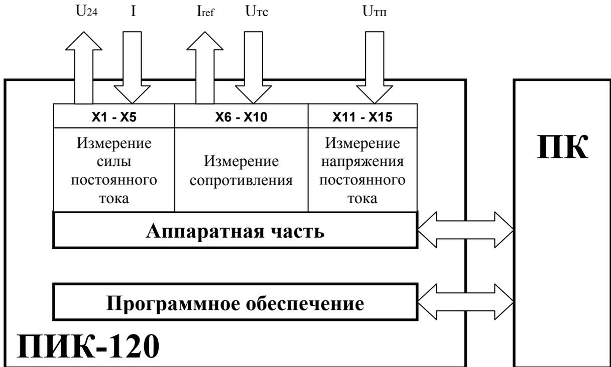
Рис.2 Функциональная схема комплекса
