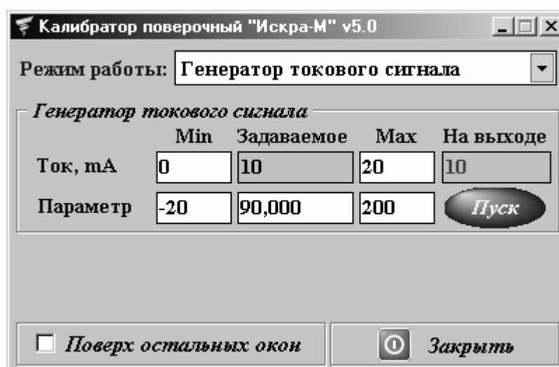
Рисунок 2 – Внешний вид программы в режиме «Генератор токового сигнала».
