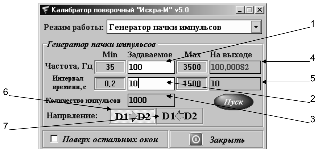
Рисунок 15 – Внешний вид программы в режиме «Генератор пачки импульсов».
